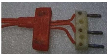
*Fil déconnecté du côté de la prise à 3 broches : ces pannes sont dues à un arrachement accidentel : il faut démonter, recouper et rebrancher les fils sans les intervertir. Faire attention au sens de montage du capuchon.*
